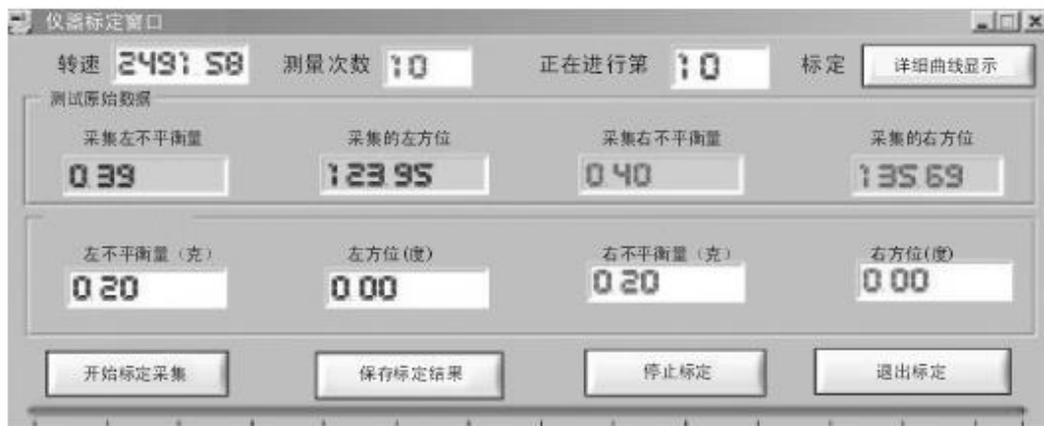
进行标定的前提是有一个已经平衡了的转子，在已经平衡了的转子上 A、B 两面加上偏心重量，所加的重量（不平衡量）及（方位角），可从“标定数据输入窗口”输入，启动装置后，通过点击“开始标定采集”来开始标定。“测试次数”自行设定，次数越多标定的时间越长，一般 5~10 次。“测试原始数据”栏只是观察数据，只要有数据表示正常，反之为不正常。“详细曲线显示”可观察标定过程中数据的动态变化过程，来判断标定数据准确性。
